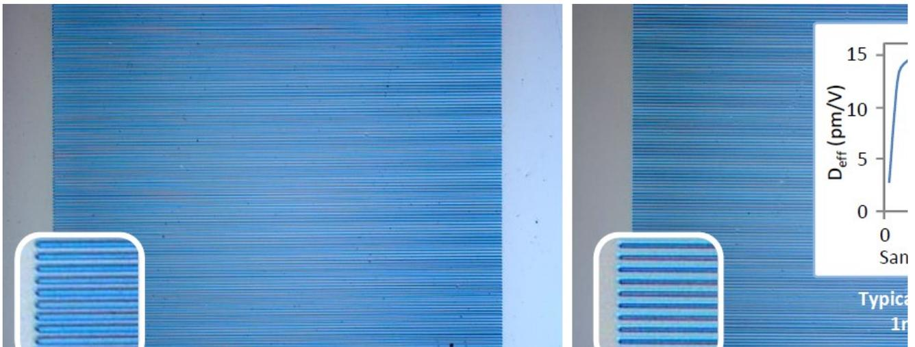
我们的 MgO:PPLN 晶体设计得能够用于大范围的常见激光波长。每种现货产品都包括多种周期，以应用于不同温度和波长。MgO:PPLN 具有 30~200°C 的大运行温度范围。用于短脉冲飞秒激光器的晶体长度为 0.3mm~1mm，用于 ns 到连续激光系统的为 10mm~40mm。我们的标准晶体都是现货，装配在夹具上。我们可根据要求定制晶体长度、厚度、增透膜和周期设计。
